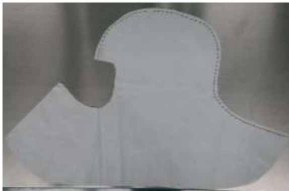
รูปที่ 10 นำผ้า 2 ชั้นประกบกัน เย็บตามรอย ประคังรูป จากหน้าผากจนถึงด้านหลัง
