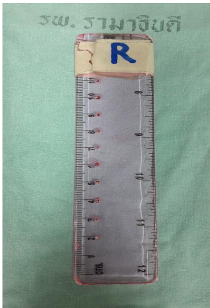
ภาพที่ 1 แสดง ไม้บรรทัดตะกั่ว (Lead marker ruler) ภาพที่ 2 แสดงวิธีการใช้งานโดยวางบนแผ่นรับภาพรังสี
