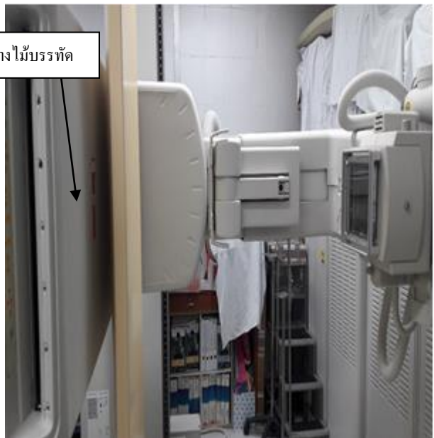
ภาพที่ 1 แสดง ไม้บรรทัดตะกั่ว (Lead marker ruler) ภาพที่ 2 แสดงวิธีการใช้งานโดยวางบนแผ่นรับภาพรังสี
