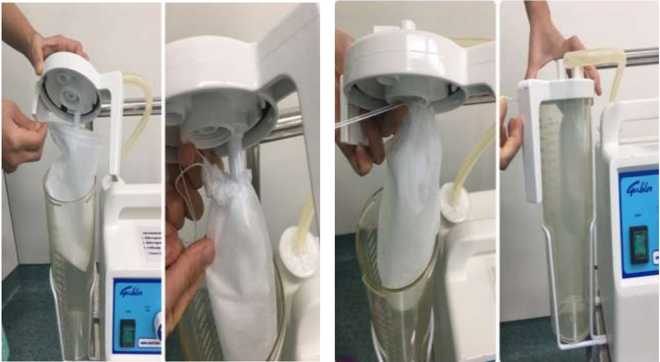
รูปที่ 6 เปิดฝาเครื่อง นำถุงกรองเนื้อกรอบบริเวณท่อ
