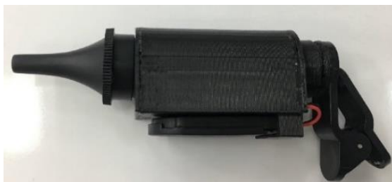
ภาพที่ 1.1 แสดงอุปกรณ์เชื่อมต่อกับกล้องส่องหูกับโทรศัพท์มือถือ รุ่นที่ 2
