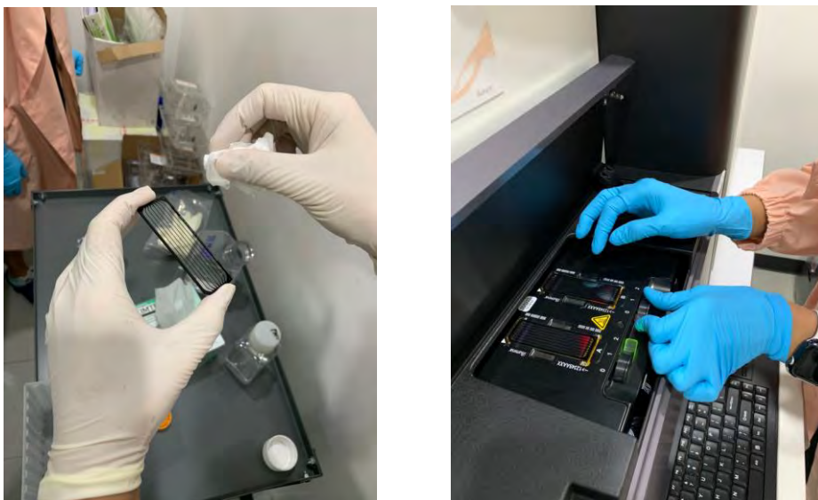
ภาพที่ 4.101 แสดงภาพขณะปฏิบัติงานขั้นตอน SEQUENCING ด้วยเครื่อง HiSeq-X
