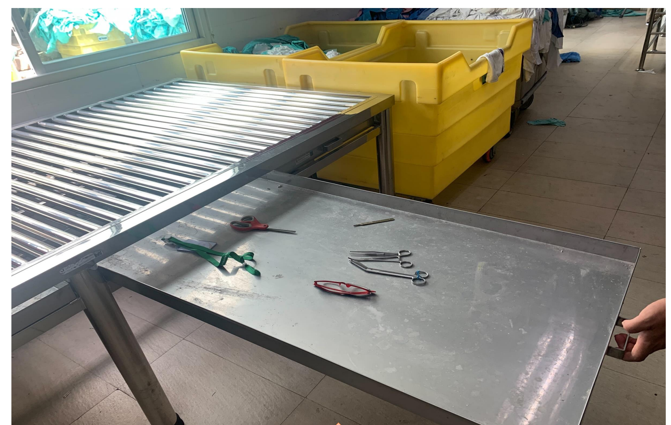
คัดแยกผ้าเปื้อน ถ้ามีสิ่งแปลกปลอมปนมา จะหล่นลงที่ถาดรองด้านล่างตะแกรง
