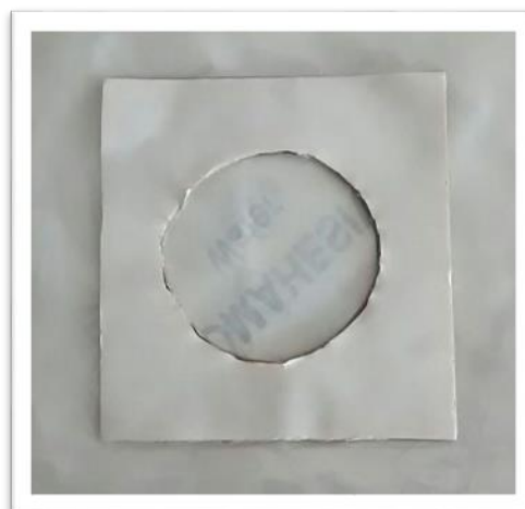
ภาพที่ 26 การตัดรูเปิดของแป้นออกทั้งหมด
