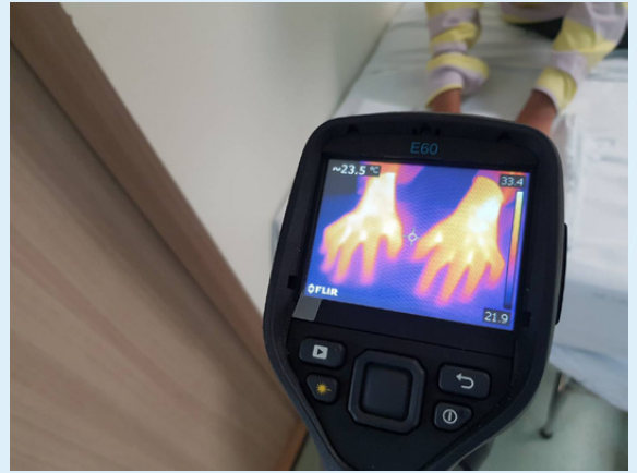
thermographic camera เป็นกล้องที่ใช้วัดรังสีอินฟราเรด
